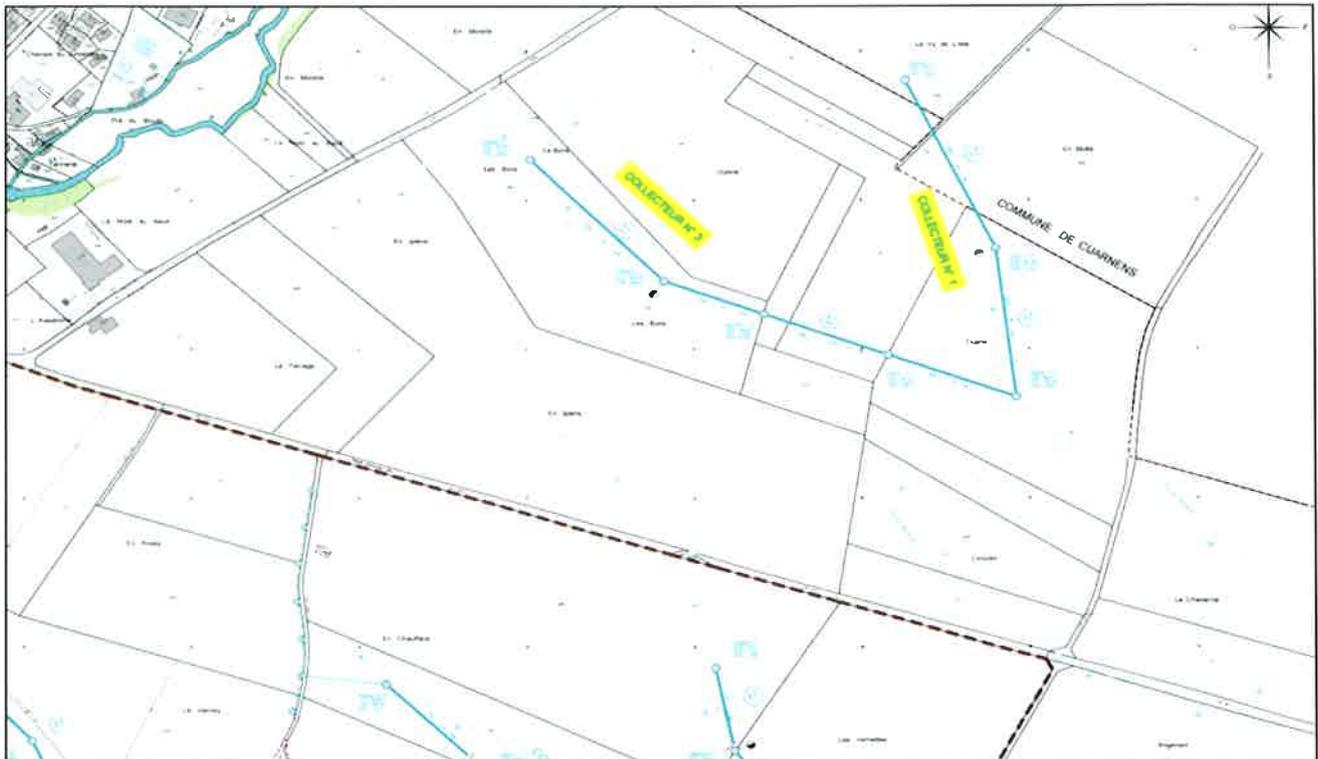
Les tronçons des collecteurs en mauvais état seront remplacés par des tuyaux de diamètres identiques.
