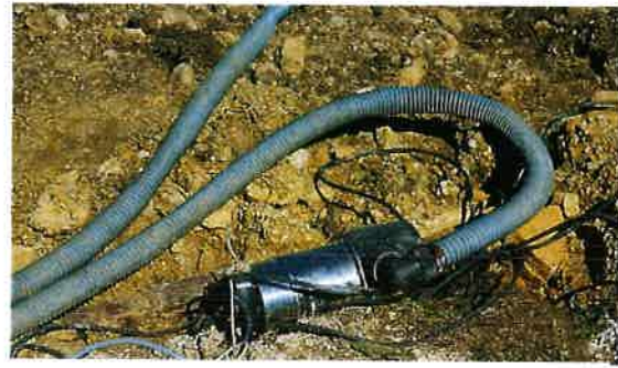
Pompe solaire immergée
